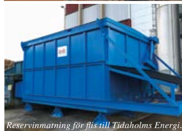
Reservinmatning för flis till Tidaholms Energi.
